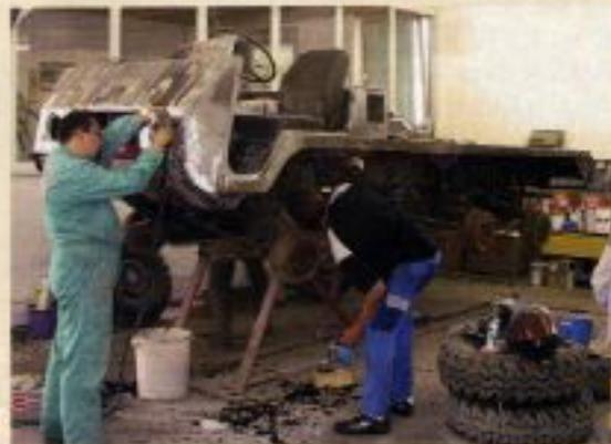
Um den Wagen Instand zu setzen, musste er komplett zerlegt werden.
